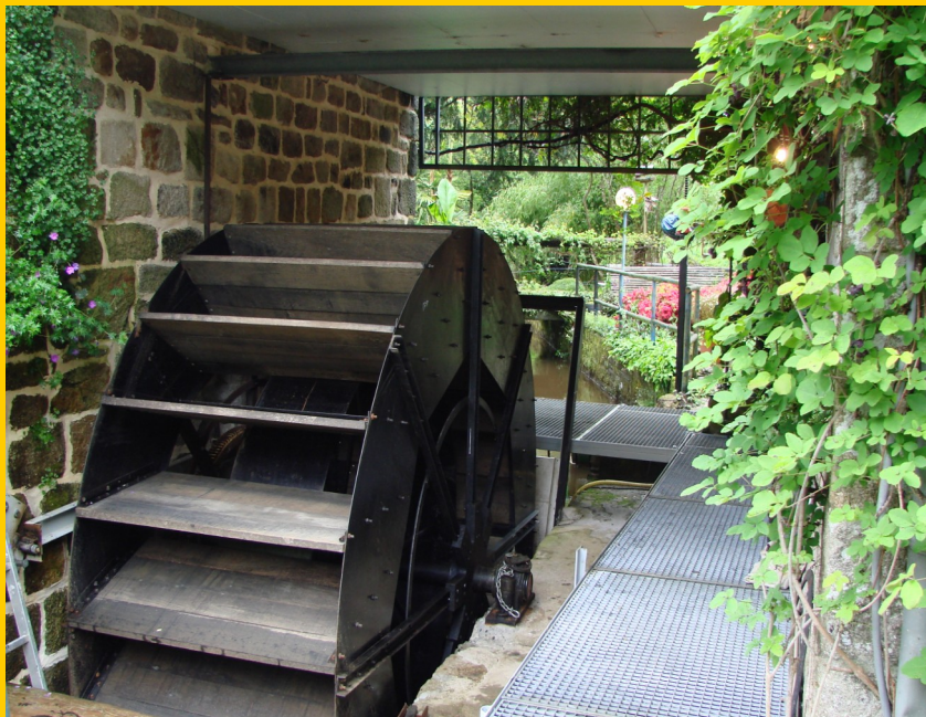
La roue du Moulin des Salles (Quimper), rénovée, entraîne une génératrice de 15 kW
